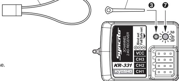
**③** 付属のバインディングスティックを使ってバインディングボタンを押したままにします。
