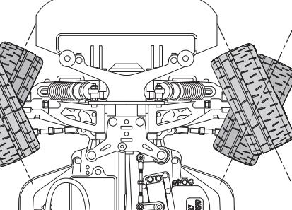
\* ステアリングホイールの操作量に応じて舵角が変わります。操作量が大きいほど、舵角も大きくなります。
