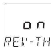
「SEL」キーを押し REV 設定画面を呼び出し、「CH」キーを押して「REV-TH」の表示にし、その際「ON」になっていればリバースに設定されています。
