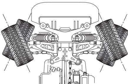
\* ステアリングホイールの操作量に応じて舵角が変わります。操作量が大きいほど、舵角も大きくなります。
