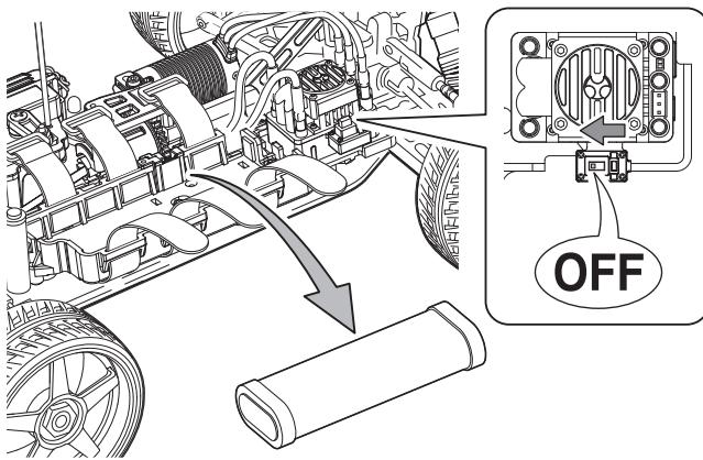
▶ 走行後や、走行させない時は必ず電源スイッチをOFFにし、車体と送信機の電池を取り外してください。誤作動や電池の発熱・液漏れなど危険な場合があります。
