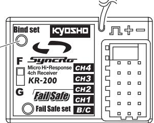
\*バインディングされない場合は受信機のバインディングスイッチを数回押し続けてください。
