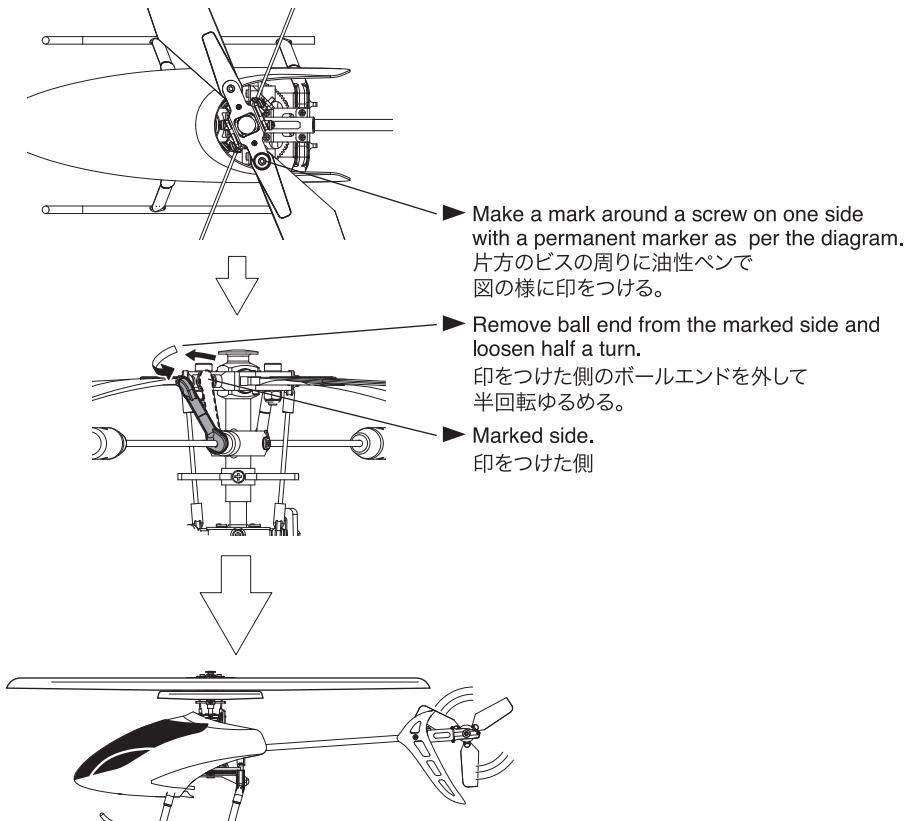
Once the difference in rotor height narrows, continue to adjust until the rotor plane appears as a single line. If the difference in rotor height has increased, screw in the loosened ball end half a turn at a time to adjust.もう一度メインローターを回転させて、トラッキングを確認します。ズレが小さくなったら、一直線に見えるまで、同じ調整を繰り返します。もし、さっきより大きくズしていたら、ゆるめたボールエンドを半回転ずつ締め込んで調整します。
