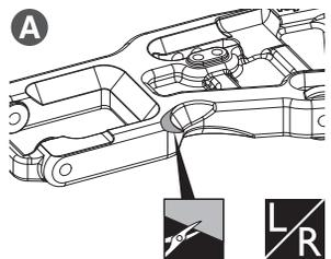
サスアームにタイロッドのナットが干渉する部分をカットする。
