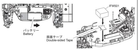
▶ バッテリーとバッテリーホルダーに隙間がある場合は、キット付属のスポンジテープで調整してください。 If there is a gap between the battery and the battery holder, adjust it with sponge tape included in the kit.
