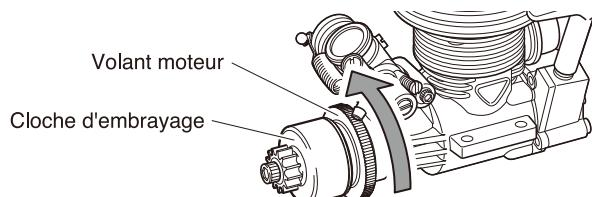
\* Le ralenti moteur, c'est lorsque le volant moteur est en rotation alors que la cloche reste statique.
