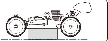
► ステアリングホイールを操作してフロントタイヤの動きをチェック。
