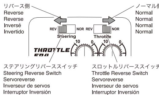
ステアリング、スロットルの動作方向を反転させる時に使用します。
