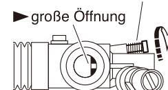
Drehen gegen den Uhrzeigersinn verringert die Leerlaufdrehzahl
