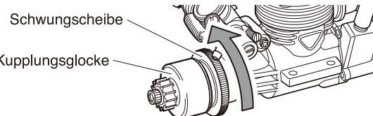
\* Leerlauf bedeutet, dass sich die Schwungscheibe noch dreht, die Kupplungsglocke aber still steht.
