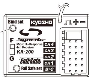
\*バインディングされない場合は受信機のバインディングスイッチを数回押し続けてください。
