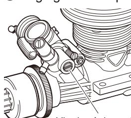
Serrer la vis en laissant toujours une ouverture de 0,4 - 0,5mm
