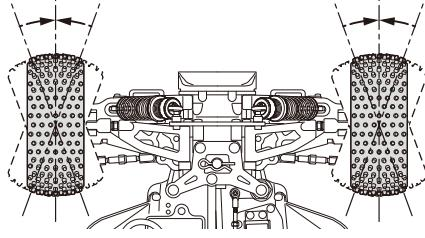
●シャシーのスイッチを "ON" にした時、フロントタイヤが左右に曲っている場合に調整します。
