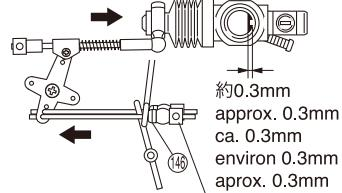
► スッパーの取付け位置でブレーキの強弱が調整できます。
