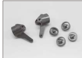
アルミナックルアーム(L/R ブッシュ付) Aluminum Knuckle Arm (L/R With Bush) No.1FW332 ★9975 ブッシュ(アルミナックルアーム用/4pcs) Bush (For Aluminum Knuckle Arm/4pcs) No.1FW332-01 ★525 (69)と交換。 Replaces (69).
