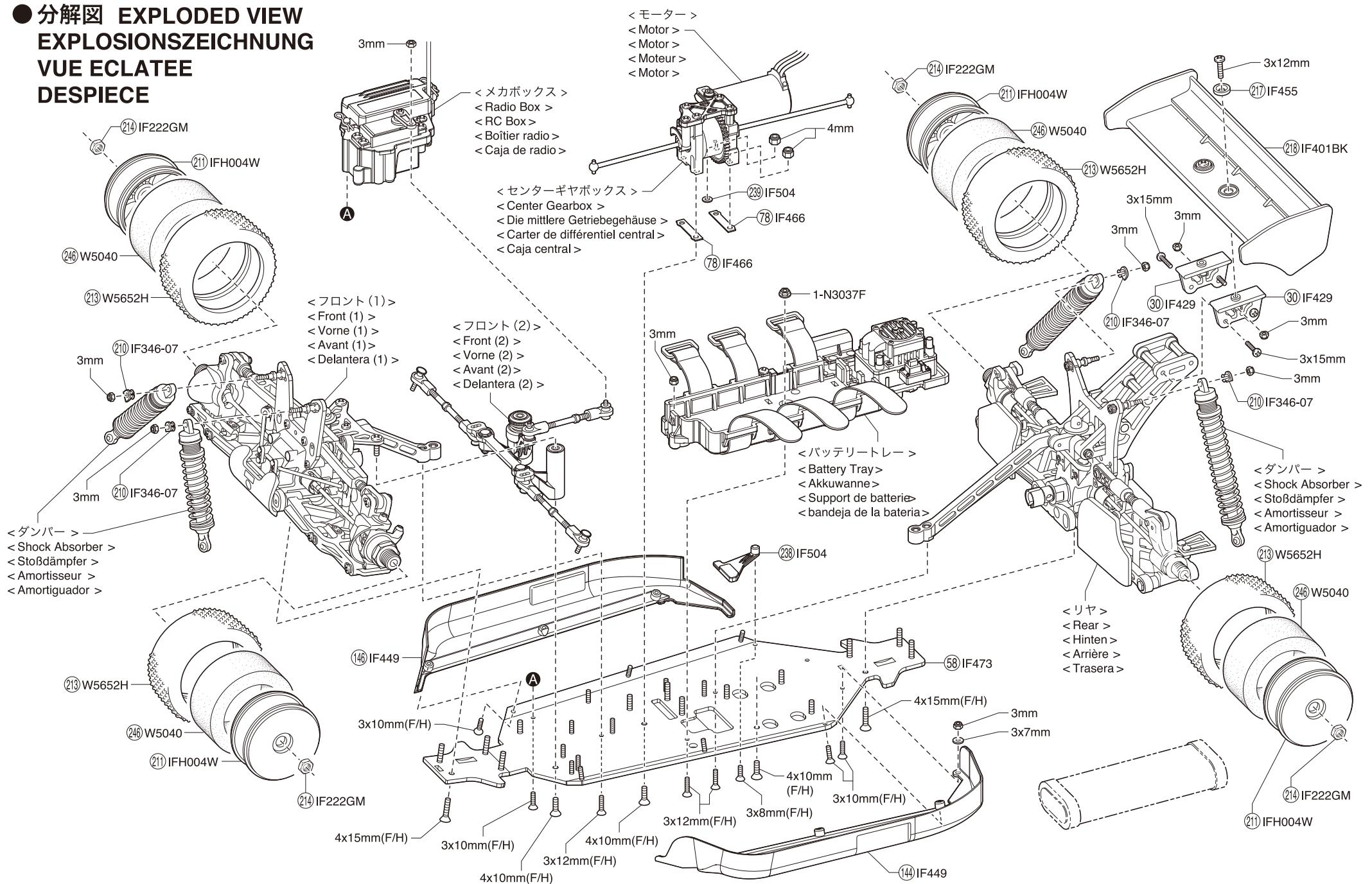
分解図 / Exploded View / Explosionszeichnung / Eclaté / Despiece
