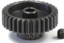
UM333 *600 スチールピニオンギヤ(33T) 1/48ピッチ Steel Pinion Gear(33T) 1/48 Pitch
