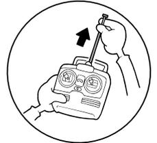
送信機のアンテナが一番伸びている事を確認し、送信機と機体の動作を確認。
