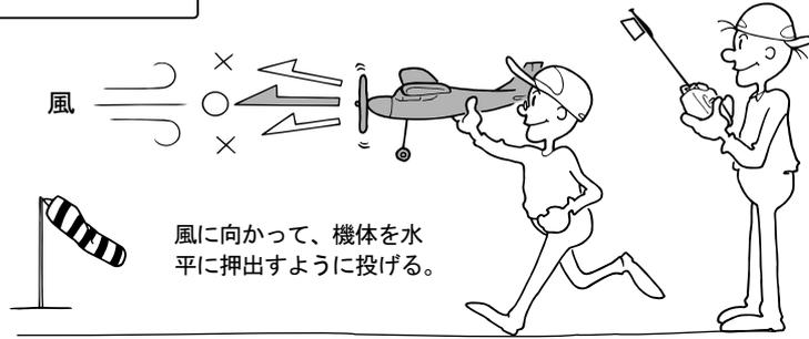
風に向かって、機体を水平に押出すように投げる。
