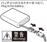
プロペラの回転に注意する。 アンプの種類によっては、コネク ターを接続しただけでモーター (プロペラ)が回転する事もある。 Beware of spinning propellers! With some electronic speed controllers, the motor (propeller) starts spinning as soon as battery is connected.
