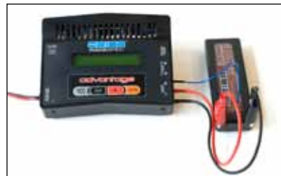
Collegamento batteria LiPo per auto (con cavetto bilanciamento SLPB)
