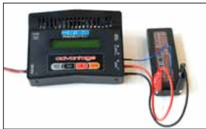
カー用バッテリーの接続 (SLPBバランスコードを使用)
