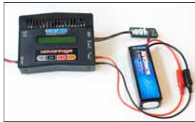
Collegamento batteria LiPo con adattatore bilanciamento
