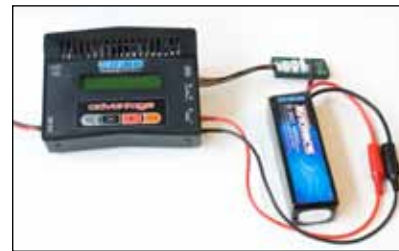
Collegamento batteria LiPo con adattatore bilanciamento
