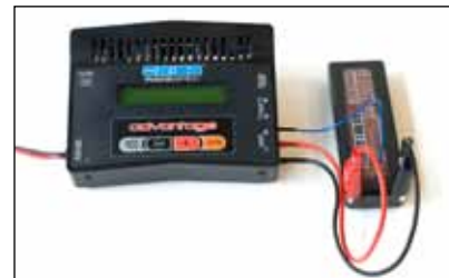
Connexion d'une batterie LiPo pour voiture (avec câble d'équilibrage SLPB)
