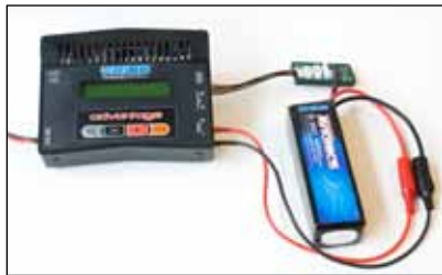
Connexion d'une batterie LiPo avec adaptateur d'équilibrage
