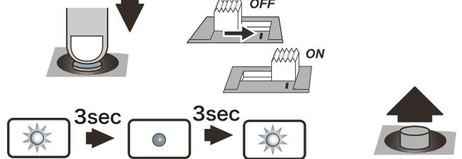
**3** LEDの点滅回数を見ながら、ニュートラルブレーキの強さをセットします。点滅回数で現在のニュートラルブレーキ量を現します。出荷状態は**モード3**にセットされております。セットボタンを押すと、モードが切り替わります。6回点滅でセットボタンを押すと、1回点滅に戻ります。
