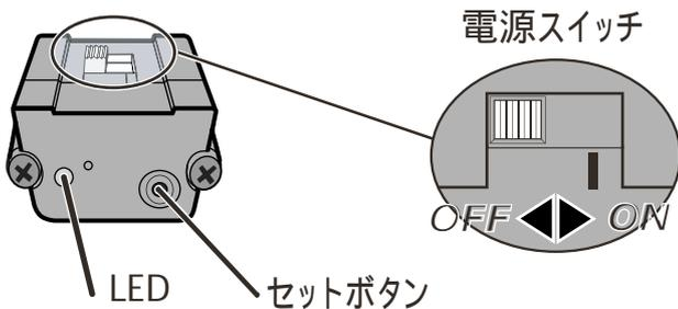
**2** セットボタンを押しながら、電源スイッチをONにします。3秒後にLEDが消灯になり、さらに3秒後に点灯します。LEDが再点灯したら、セットボタンを離します。
