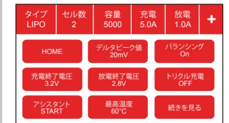
LiPo、LiFe、Lilonバッテリーでは必ずバランス機能をj用してください。(1セルを除く)。バランス機能がオンになっている場合は、バランスコネクタが接続されている必要があります。バランス機能が無効になっている場合、充電時の安全性が損なわれます。トリクル充電が有効(ON)になっている場合、電池を許容充電時間以上に充電器に接続しないでください。しかし、あなたがそれらの機能を十分に理解している場合に限りこれらの設定を変更してください。安全タイマー(セーフティタイム)が充電器のすべての機能に対して動作しています。
