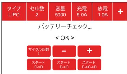
(充電→放電、放電→充電、放電→充電→放電) ボタンを押すとサイクル充放電が開始されます。
