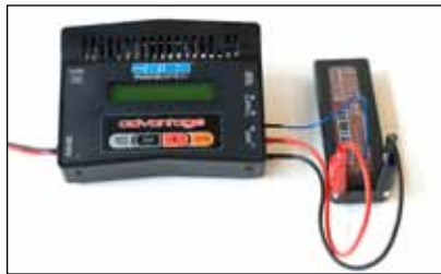
Collegamento batteria LiPo per auto (con cavetto bilanciamento SLPB)
