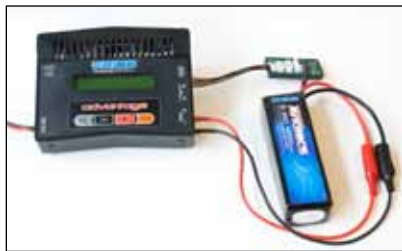
Anschluss eines Akkus mit dem Balancer Adapter
