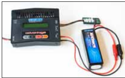
Collegamento batteria LiPo con adattatore bilanciamento
