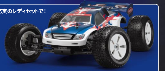
高効率を極めたリコイルスターター・装備GXR28エンジンを搭載済み。後方排気の大排気量エンジンでゆりの走り。
