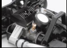
低重心の大型ヒートシンクヘッドを装備したリコイルスターター付きGZ-15エンジンを搭載済み。
