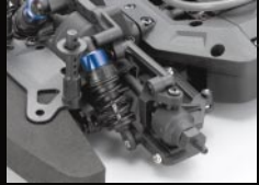
ダブルウィッシュボーン4輪独立サスペンションのそれぞれに、高性能オイルダンパーを装備。
