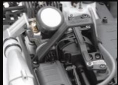
丈夫かつ高剛性を発揮するブレーキロッドをはじめ、リネージ済みのロッド類は長さ調整が不要。
