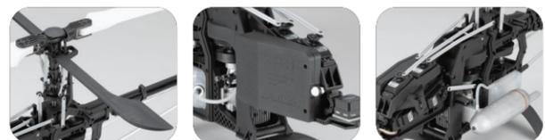
まったく新しい樹脂製上下シェル構造の対称翼のメインローターを付属。前縁部に配置したパラストで素直な操縦性と安定性を実現。スタビバー、スタビブレード、ヒラールコントロールレバーがワンユニットとなり、調整不要でベストセットが可能。上達したらキャリバー30パーツを使用して、ステップアップも可能。ベルト駆動2段減速ミッションと相まって、静かなのに力強い飛行を実現。革新的なサーボマウント駆動機構のメカニカルミキシングシステム(MMS)。軽量で丈夫なスキッド一体型軽量ブレース。受信機&バッテリーを搭載後のリード線処理が容易なメカボックス。将来性を考えた余裕のピッチストロークを確保。
