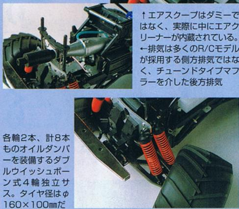
各輪2本、計8本のオイルダンパーを装備するダブルウイッシュボーン式4輪独立サス。タイヤ径はφ160×100mmだ
