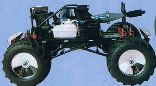
3mm厚アルミメインフレーム+強化樹脂サイドフレートで構成される強靭なシャシー構成。エンジンをフロントミッドに搭載する理想的な重量配分が、優れた運動性と加速を実現してくれる
