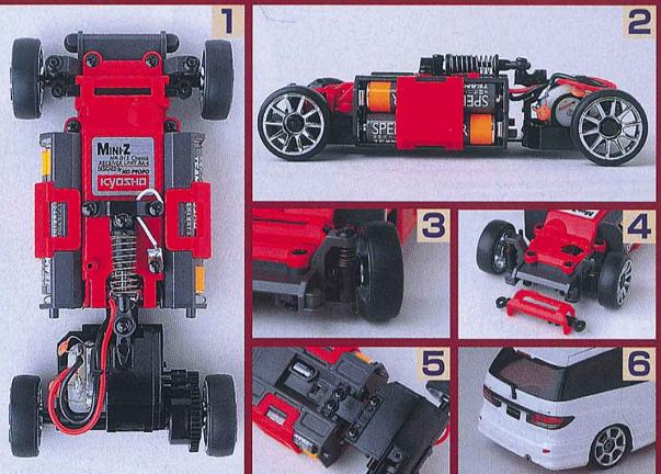
①MR-015シャシーを上から。ロングホイールベース&ナロートレッドがよくわかる。②側面。シャシーはさらにモーターの搭載位置により、ミッドマウントの「MM」、リアマウントの「RM」の2タイプに分かれ。エスティマやオデッセイに採用されたのは「MM」だ。③本格的な構造を持つサスペンション。MR-015からはシャシー側面の電池ボックス内にリブが設けられシャシー剛性が向上したこと、サスの持ち味がより引き出されている。④タイロッドをトップブリッジ式にし、ワンタッチで取り外せるようにしたため、メンテナンス性が大幅に向。⑤ホイールベースはリアシャシー基部の取り付け位置を変えることで3段階に変えることができる。⑥ダイキャストモデルに迫る再現性を実現したボディは、大人の鑑賞にも充分耐える完成度を持っている。
