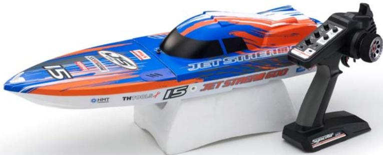
RCメカは船体一体成型の防水メカボックスでガード。さらにESC、サーボを防水することで2重に防水。G20モーターに水冷ジャケットを装備しモーターのパワーを効率化。走航姿勢調整用のメタルフラップを左右に装備。波や風の状況に応じたセッティングが可能。旋回性能をアップさせるメタルターンフィンを標準装備。高速での安定した旋回を実現しました。
