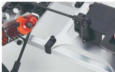
ロアデッキフロント側を樹脂製クランプパーツで固定。
