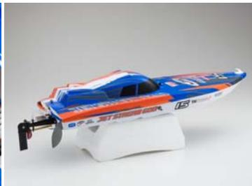
RCメカは船体一体成型の防水メカボックスで 走航姿勢調整用のメタルフラップを左右に装備。転覆自動復帰機構で初心者も安心して楽しめます。さらにESC、サーボを防水する事で2重に防水。
