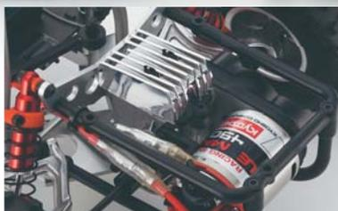
スピコン用抵抗のヒートシンクは樹脂成型品にメッキで再現しメッキ仕上げを施す。
